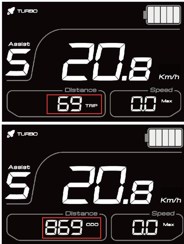
g) Per cambiare l'unità di misura da da km/h a mp/h o viceversa premere e tenere premuto il tasto **SET** sulla pulsantiera, dopo 5 secondi si aprirà il menù premere nuovamente il tasto **SET** fino ad arrivare alla schermata in figura, con i tasti più o meno selezionare l'unità di misura desiderata.
