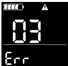
Errore del segnale Hall del motore
